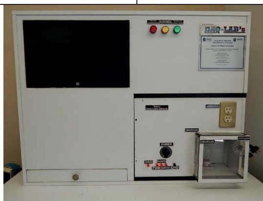
CONSOLA DE PRUEBAS CON SISTEMA DE ADQUISICIÓN DE DATOS (LAB VIEW), PARA CABINA DE PRUEBAS DE MOTORES DE COMBUSTIÓN INTERNA (MAGNITUD DE TEMPERATURA)
