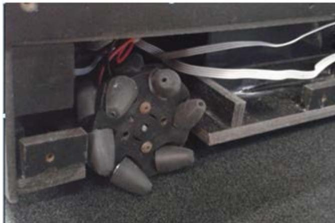
**Figura 7. Rodamientos Mecanum**
