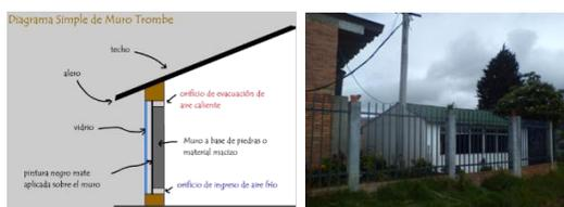
**Figura 3 a) Principio de funcionamiento de un muro Trombe. 3b) Foto de la escuela donde se instaló el muro Trombe**
