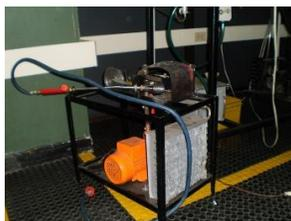
**Figura 5. Prototipo de motor Stirling para su posterior generación de energía eléctrica en zonas aisladas**
