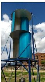
**Figura 4. Turbina eólica tipo Savonius de doble cuerpo construida para un sistema de iluminación solar eólico en la Universidad Distrital FJC**
