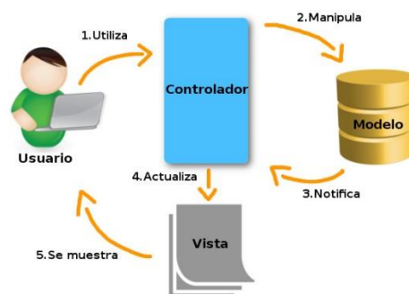
Figura 2. Patrón arquitectónico MVC. Alvizu (2016).
