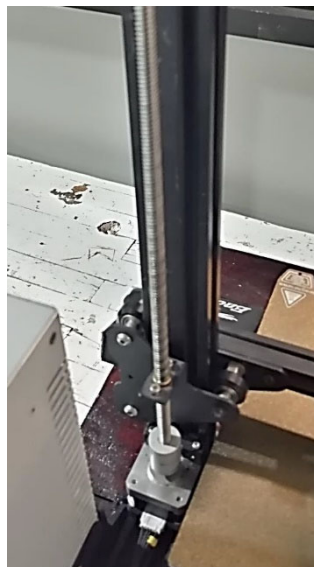
Figura 6. Integración de un segundo eje z en el marco de la impresora 3D (lado derecho).
