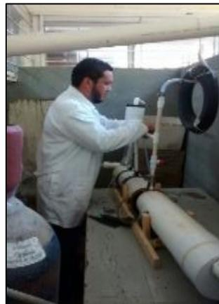
*Figura 1.* Prototipo de un biodigestor de flujo semicontinuo.
