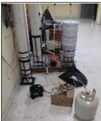
*Figura 6.* Sistema de compresión de biogás. Elaboración propia.
