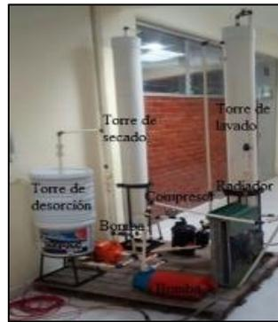
*Figura 2.* Prototipo de un sistema físico de purificación de biogás.
