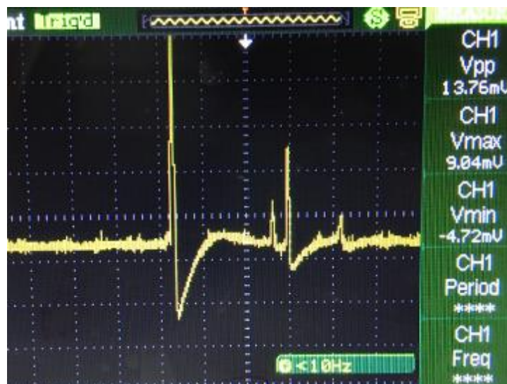
Figura 12. Forma de la señal electromiográfica con solo pulso observada en osciloscopio. Elaboración propia
