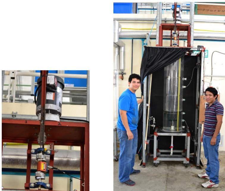
**Figura 1. Sistema construido. a)Acoplamiento motor – Torquímetro
