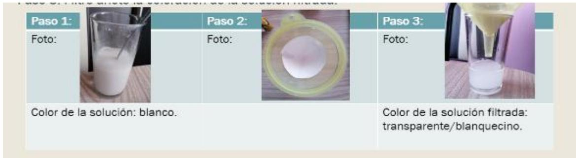
**Figura 7.** Ejemplo de la operación de filtración realizado correctamente, evidenciado en un reporte.
